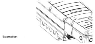
Figure 52: Inverter external fan
